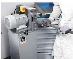
Возможна поставка GRIT GXE как в настольном исполнении, так и комплектация стойкой или ящиком с принудительным пылеотсосом. Опорные стойки с пылеотсосом имеют кассетные фильтры для эффективной очистки воздуха.
